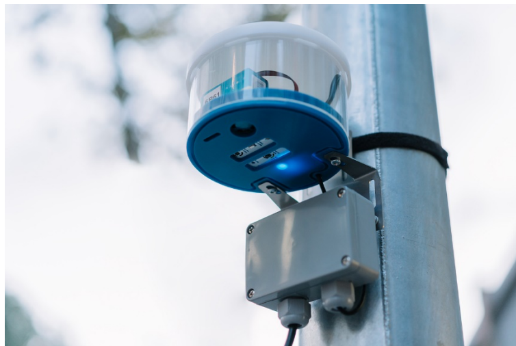
Figura 2 | Stazione di monitoraggio Smart citizen Kit; iScape (2019). Fonte: www.iscapeproject.eu .
