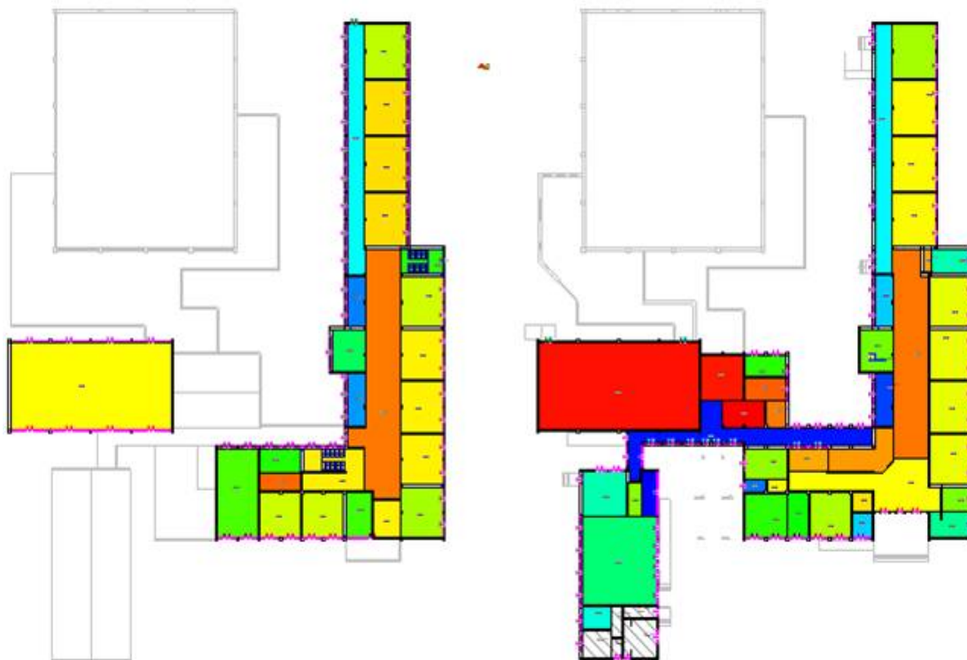
Figura 1. Plesso scolastico. Analisi dispersioni termiche nel plesso scolastico pre-intervento.
