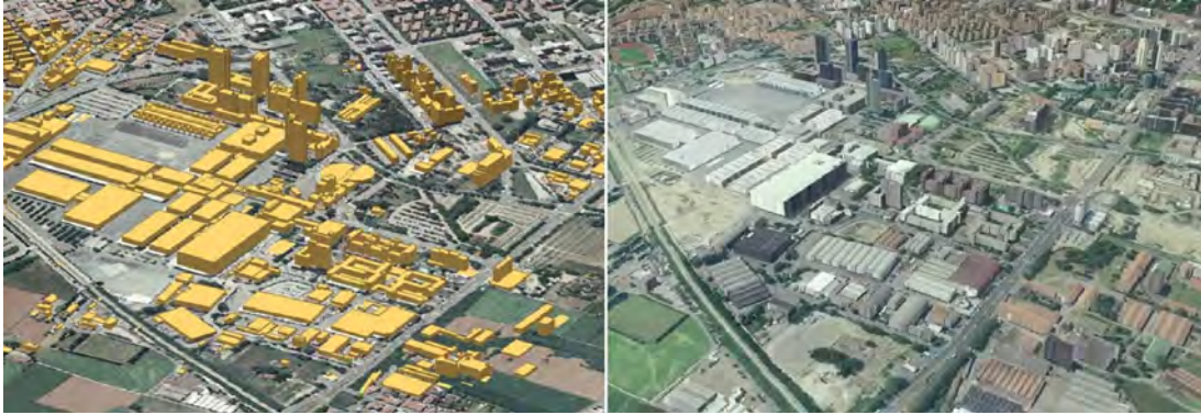
Esempio di modellazione tridimensionale dell'edificato, ottenuta grazie ai dati di quota degli edifici acquisiti durante la realizzazione della Carta Tecnica Comunale.
