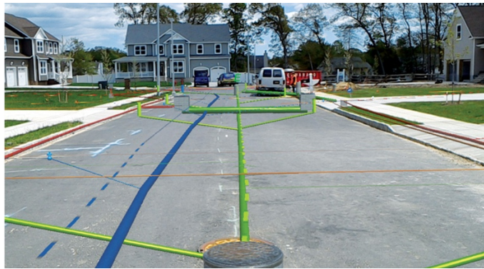
Figura 3 | Applicazione VGis (Esri e Meemim) per la visualizzazione delle utility urbane con codifica a colori.
