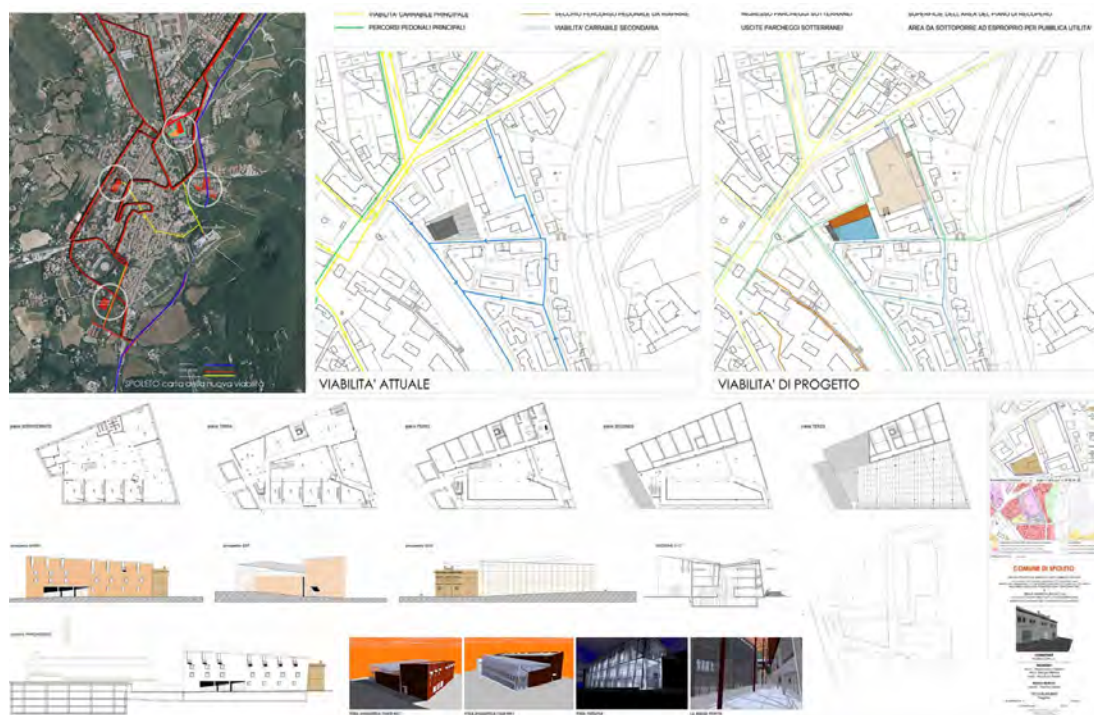
Piano attuativo nel CdQII, nell'area delle ex officine Fiat, di iniziativa mista. Sistema di viabilità e sosta, confronto tra stato attuale e di progetto (sopra) e progetto architettonico (sotto).
